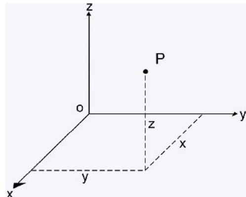
sendo  $N$  a grande normal ao elipsoide de referência à latitude  $\phi$ ,  $h$  a altitude elipsoidal do ponto e  $(a, e^2)$  os seus parâmetros de forma. Estas expressões correspondem à transformação direta das coordenadas geodésicas ( $\phi$ ,  $\lambda$ ,  $h$ ) de um ponto nas correspondentes coordenadas cartesianas tridimensionais ( $X$ ,  $Y$ ,  $Z$ ).
