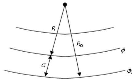
sendo  $R$  o raio vetor de um dado paralelo (à latitude  $\phi$ ),  $R_0$  o raio vetor do paralelo de referência (à latitude  $\phi_0$ ),  $N_0$  o raio de curvatura na direção da primeira vertical perpendicular à direção do meridiano (à latitude  $\phi_0$ ),  $r$  o raio de paralelo à latitude  $\phi$  e  $\sigma$  o arco de meridiano entre os paralelos.
